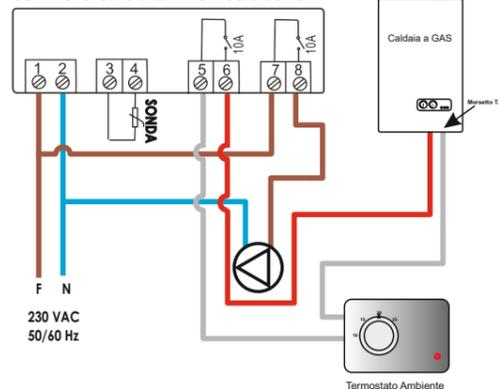
P1= pompa termoprodotto (solo HB30) P2= Pompa impianto
